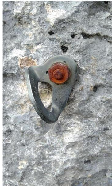
Anclajes tipo “parabolt” oxidados y con desconchados en la roca sustituidos en Bordillos.
